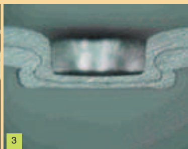
Figuur 2. Rechthoekige Eckold klinkverbinding tussen Nirosta H400 1,4 mm sandwich (boven) en rvs 304 1 mm (onder).
